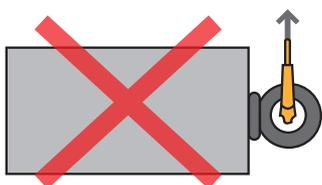
多点吊りでアイボルトの座面がワークに密着しないと…
