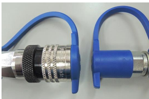
[写真12] 防じんキャップ取付状態
