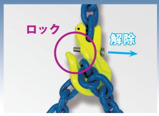
チェーン外れ防止のロックピン付グラブフックです。 長さ調整、バスケット吊りに使用します。
