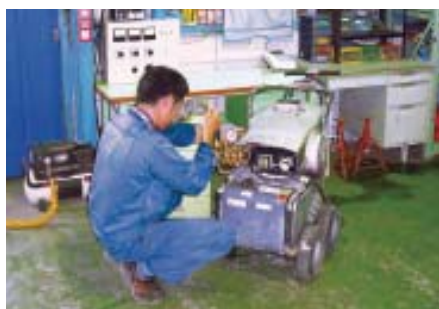
高圧洗浄機を修理する弊社エンジニア
